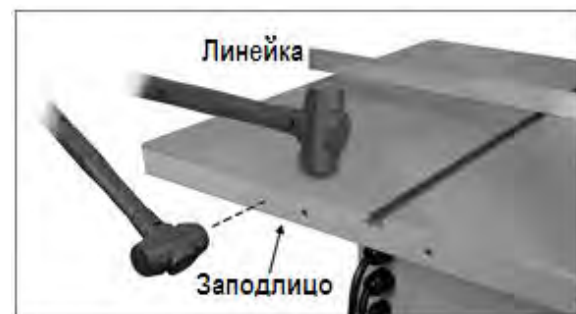
Рисунок 6-4: Выравнивание расширений, Метод 1
